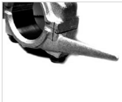
На двигателях Honda используется стандартная система разбрызгивания масла.
