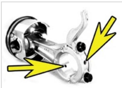
Масло подается к шатунной шейке коленчатого вала через два смазочных отверстия в шатуне. Диаметр шейки рассчитан на большой поток масла.
