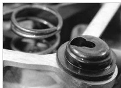
В двигателях Honda применены более дешевые цельные съемные замки тарелок клапанов. Если во время работы клапан соскальзывает, двигатель получает серьезные повреждения.
