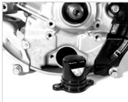
В датчике масла в двигателях Robin Subaru применен поплавковый рычажного типа, обеспечивающий максимальный срок службы. Датчик выдержит паузу 5 секунд перед выключением зажигания. Расположен на передней части двигателя для легкого доступа.
