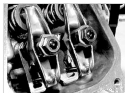
В двигателях Honda используются более дешевые клапанные коромысла из штампованной стали. Требуется чаще проводить регулировку клапанных зазоров.
