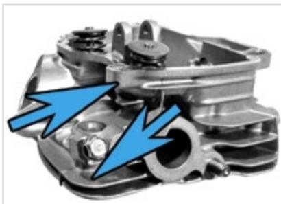
Охлаждение блока головки цилиндров чрезвычайно важно для увеличения продолжительности срока службы двигателя. Конструкция ОНС позволяет охлаждать потоком воздуха зоны штоков выпускного и впускного клапанов по всей окружности.
